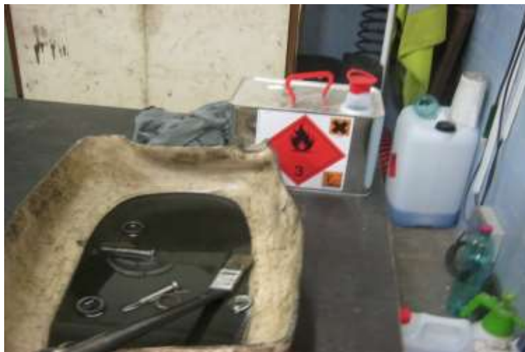
Obrázek 4 - Právnická, ale i podnikající fyzická osoba, musí dodržovat všechny právní předpisy PO, včetně správného uložení chemických látek. Tento obrázek ukazuje nevhodné uskladnění.
